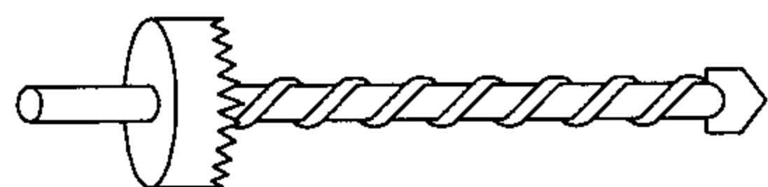
大孔，直孔双功能钻 (用于穿墙螺栓加垫板固定物件)
